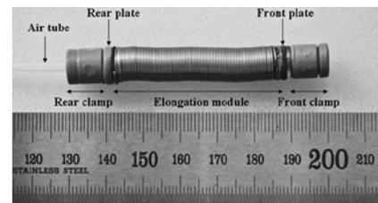
Fig. 15. Inchworm prototype microrobot[15].
