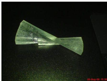
شکل ۱: شکل سمت راست: قطعات استاندارد محاسبه ضریب کرل [۱]. شکل سمت چپ: خراب شدن قطعه ساخته شده در دستگاه SLA 5000 به دلیل جابجایی لایه‌ها و چرخش آنها به خاطر شکست تکیه‌گاه‌های آن در اثر بزرگی نیروهای داخلی وجودآمده در آن
