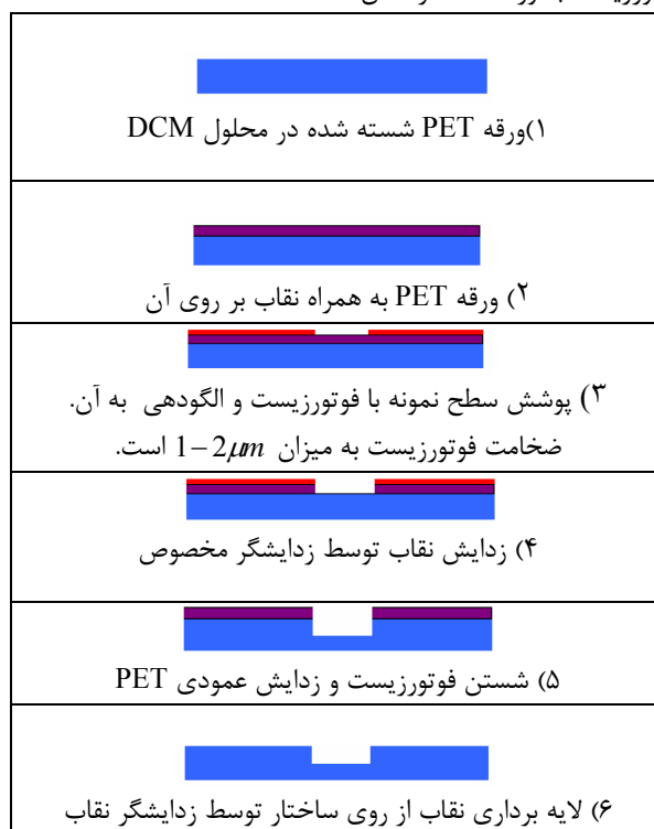
شکل ۲- مراحل مختلف آماده سازی نمونه PET، لایه نشانی و الگودهی نقاب و انجام زدایش نقاب
